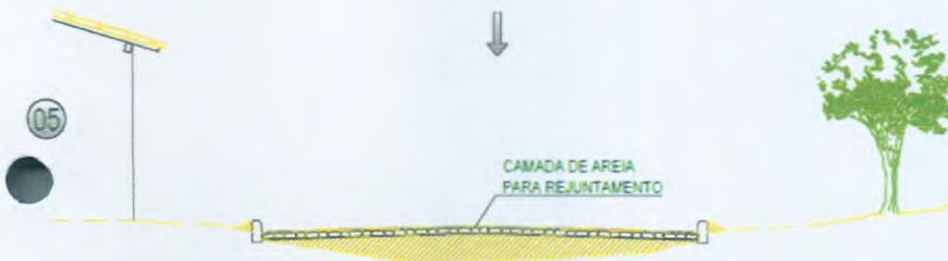
ANTES DA COMPRESSÃO COM O ROLO METÁLICO, JOGA-SE AREIA SOBRE O CALÇAMENTO, NA QUANTIDADE SUFICIENTE PARA PREENHER AS JUNTAS E FORMAR UMA CAMADA SOBRE O CALÇAMENTO DE APROXIMADAMENTE 2CM.
